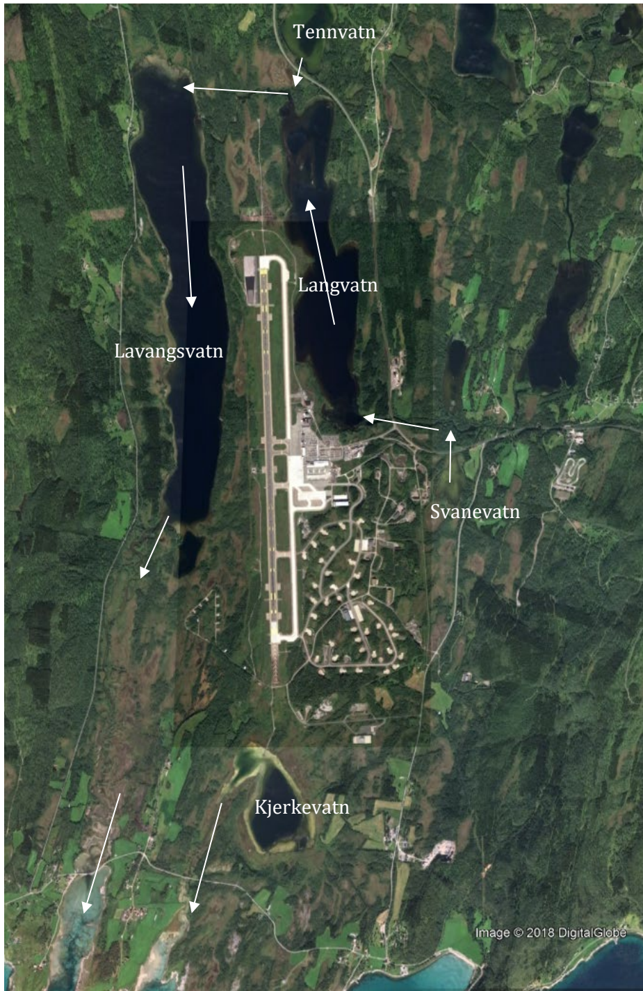
Figur 6. Kart over nedre del av vassdraget som flystasjonen drenerer til. Tennvatn ligger oppstrøms flystasjonen. Lavangsvatnet renner ut i Tårstadelva som igjen renner ut i sjøen (figur hentet fra google maps).
